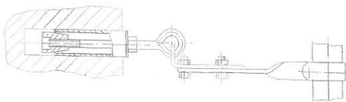
*Схема крепления лесов к стене*
