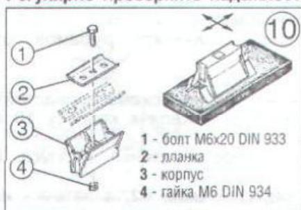
Для обеспечения правильного угла заточки ножа пользуйтесь специальным держателем (рис. 10), который входит в комплект поставки рубанка. Заточку производите по задней грани ножа, снимая минимальный слой металла. Для устранения дефектов заточки (заусенцы, сколы) и для получения качественной острой кромки ножи правьте мелкозернистым бруском.
