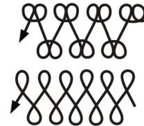
Используют для усиленного прогревания кромок шва, особенно при сварке высоколегированных сталей. Электрод задерживают на краях, чтобы не было прожога в центре шва или вытекания металла при сварке вертикальных швов.
