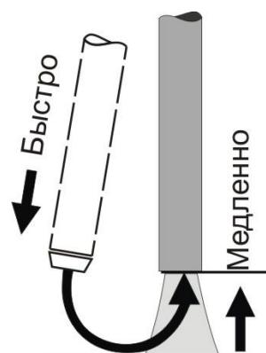
**Положения электрода при сварке**
