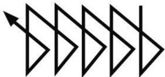
Применяют для угловых швов с катетом более 6 мм и стыковых швов со скосом кромок в любом пространственном положении. Дает хороший провар.
