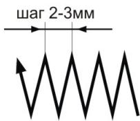
Прямые зигзагообразные движения применяют для получения наплавочных валиков при сваркестык без скоса кромок в нижнем положении и если нет вероятности прожечь деталь.
