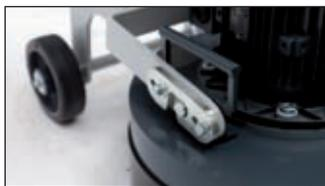
Разборная конструкция для транспортировки
