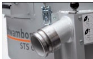
Эксцентриковый затвор - муфта для сцепления STS 40 – 60 – 110/ STA 55
