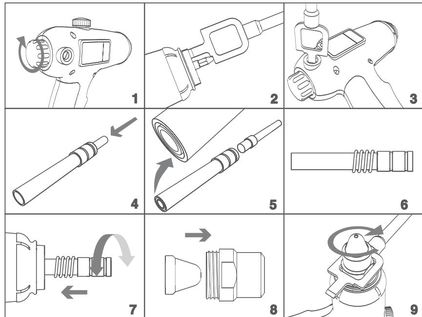
1. Закрутите стартовую кнопку по часовой стрелке до упора;
