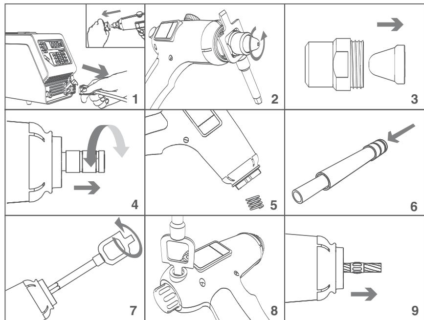
1. Убедитесь в том, что горелка не работает и горит светодиод “ВЫКЛ” (“OFF”), после чего отсоедините кабель горелки от блока питания. Снимите защитную насадку.
